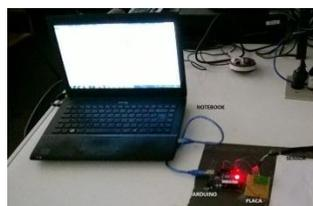
FIGURA 10 - Conexão entre notebook, Arduino, placa e sensor.
