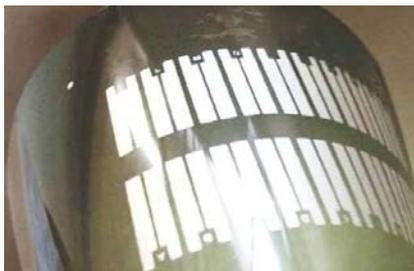
Figure 3. Eletrodos flexíveis de prata serigrafados sobre PS e usados como substratos para ejeção de uma camada de PANi e, conseqüentemente, manufatura de sensores orgânicos.
