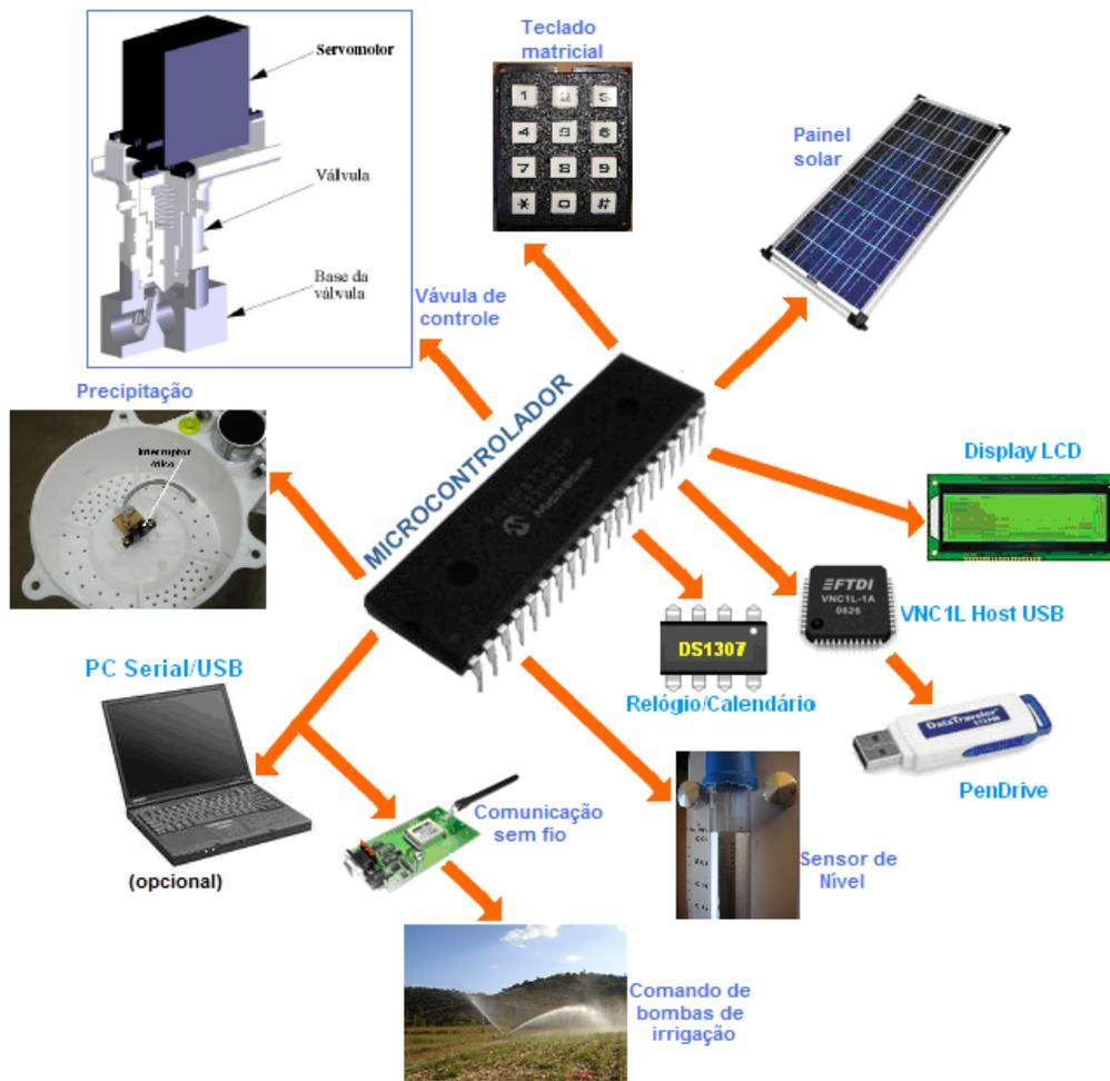
Figura 3. Esquema com aplicações em um sistema automático com o Irrigâmetro utilizando um microcontrolador
