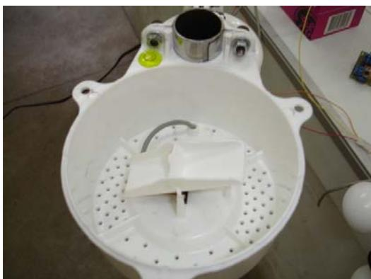
Figura 3. Sensor de precipitação pluvial com o reservatório basculante.
