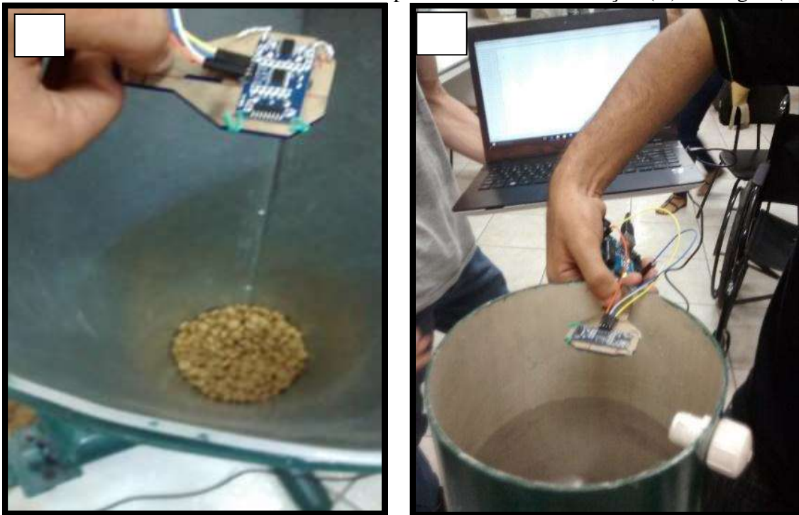
FIGURA 2 - Teste do sensor ultrassônico para medir o nível de ração (A) e de água (B)
