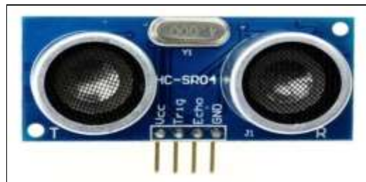
FIGURA 1 - Sensor de distância ultrassônico HC - SR04
